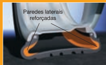
Pneus SSR: Mobilidade contínua até 80 km a uma velocidade de 80 km/h.
